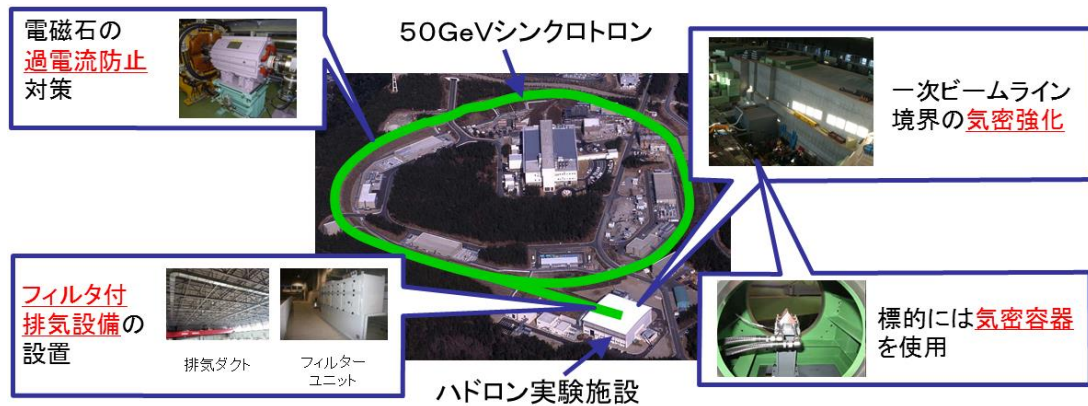
J-PARC 50 GeV シンクロトロン及びハドロン実験施設の安全対策
